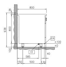
Electrical inlet (power) Equipotential screw
